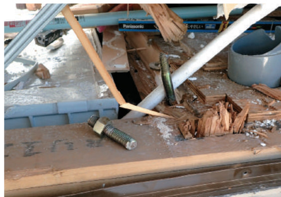
益城町で倒壊した住宅の破断したホールダウン金物
